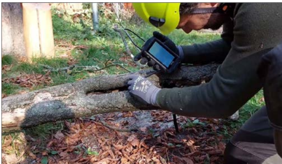
Biologický dozor může zajistit prohlídku dutin pomocí endoskopické kamery (foto: Lukáš Lollek).
