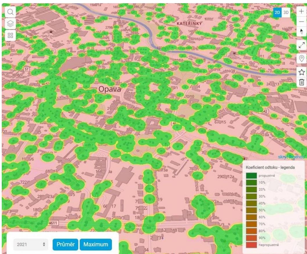
Obr. 6. Náhled na zobrazení mapy se zobrazením uličních vpustí (bodové objekty – modrá barva) a doplnění heatmapy znázorňující shluky soustav uličních vpustí – náhled na mapu města Opava
