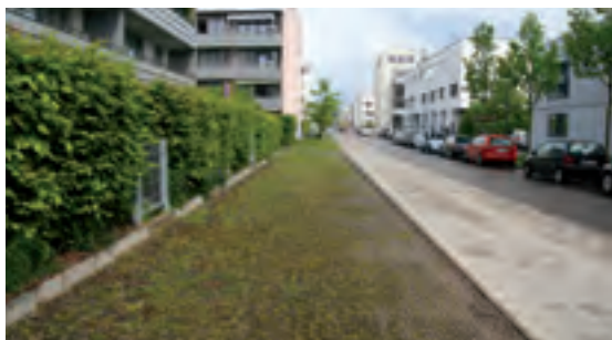
Obr. 22 Zasakovací průleh a zatravněvací plastová dlažba, Mnichov-Riem (zdroj: Veronika Kalníková)
