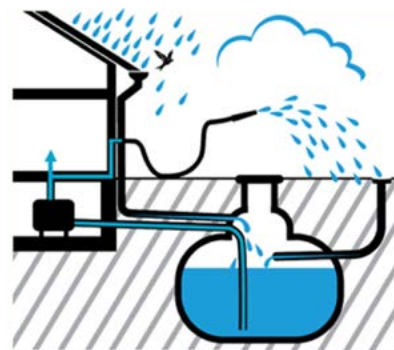
Systém využití dešťové vody k zavlažování - spotřeba pitné vody na osobu na den v Praze Zdroj: Skanska Reality, Data: PVK
